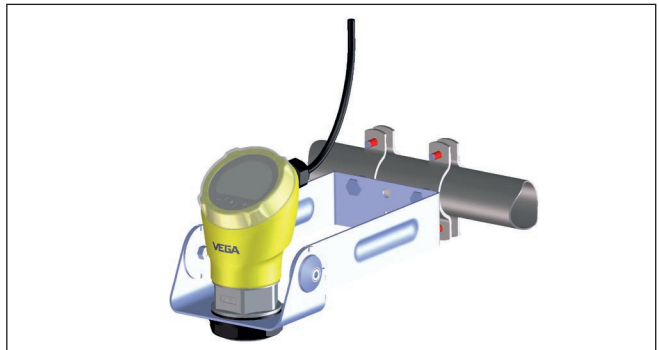
Abb. 15: Montagebügel zur Rohrmontage waagrecht über bauseitige Rohrschellen
