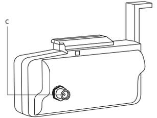
c Plug for connecting external antenna / Anschluss für eine externe Antenne / Роз'єм для підключення зовнішньої антени
