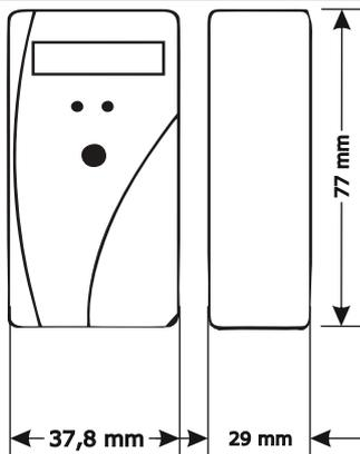
Der EHKV EURISII ist als 1-Fühler- und 2-Fühlergerät erhältlich. Er kann mit optischer und/oder Funkschnittstelle geliefert werden. Als Funkprotokoll kommt das W-MBUS Protokoll nach DIN EN13757-4 im T1 oder S1 Modus zum Einsatz. Die übertragenen Daten können dabei mit AES128 nach OMS Standard verschlüsselt werden.
