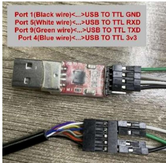
Verwenden Sie dann ein DuPont-Kabel, um Port 3 und Port 1 kurzzuschließen, und lösen Sie sie anschließend wieder, damit das Gerät in den Bootload-Modus wechselt.
